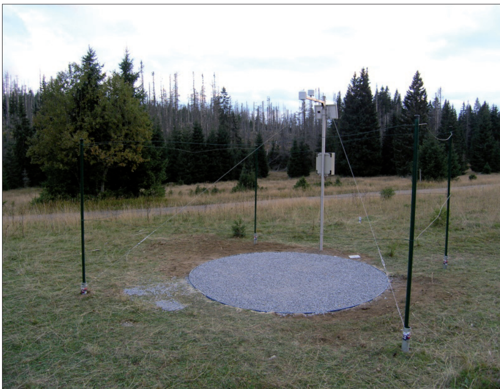
Obr. V.47 Automatická sněhoměrná stanice se senzory měřícími hydrostatický tlak v polštáři naplněném směsí nemrznoucí kapaliny a vody. Lokalita: Javoří Pila na Šumavě.
