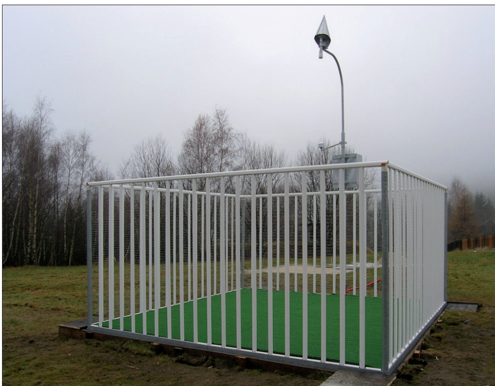
Obr. V.46 Automatická sněhoměrná stanice s tenzometrickými senzory umístěnými v rozích měřicí desky. Lokalita: automatická klimatologická stanice Desná – Souš v Jizerských horách.
