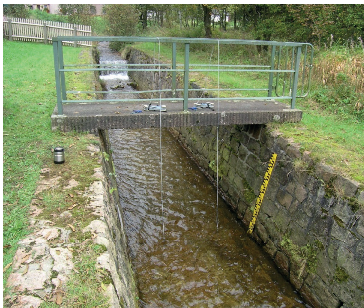
Obr. V.13 Sada TQ-S a příklad použití sond pro měření průtoku v regulovaném korytě. Zdroj: ČHMÚ. Fig. V.13 Tracersystem TQ-S and an example of measurement in a regulated channel. Source: CHMI.
