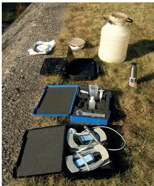
Obr. V.13 Sada TQ-S a příklad použití sond pro měření průtoku v regulovaném korytě. Zdroj: ČHMÚ. Fig. V.13 Tracersystem TQ-S and an example of measurement in a regulated channel. Source: CHMI.
