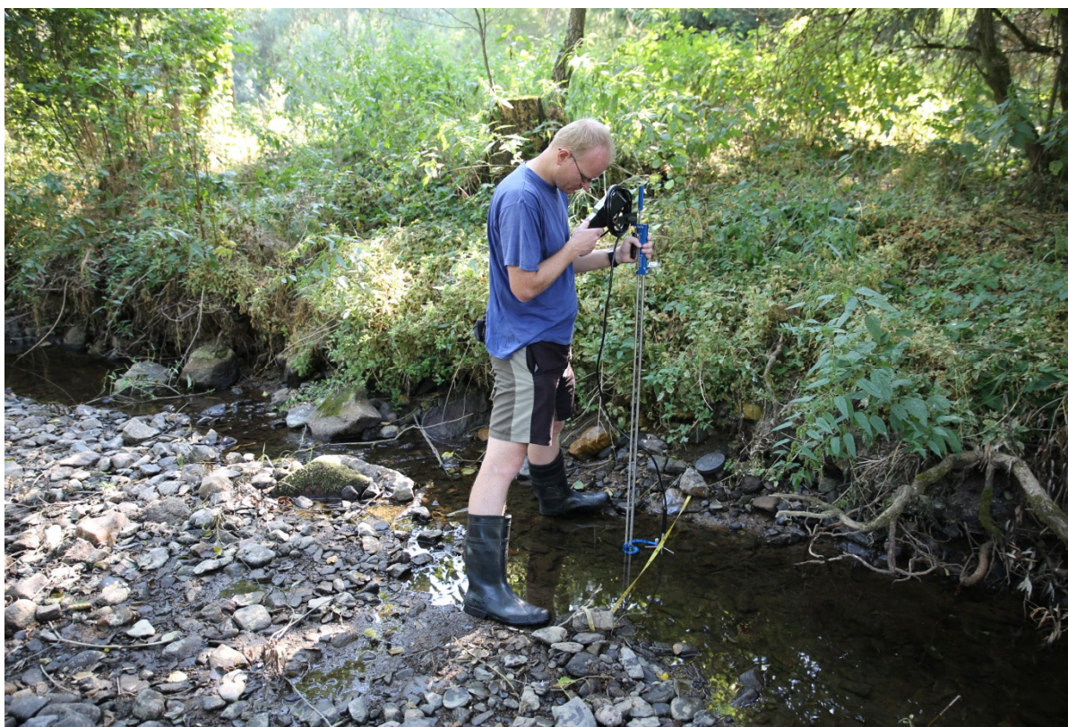
Foto 1 Měření průtoku přístrojem FlowTracker v profilu Hrachov na toku Brzina. (7. srpen 2015, foto Lucie Petrová).
