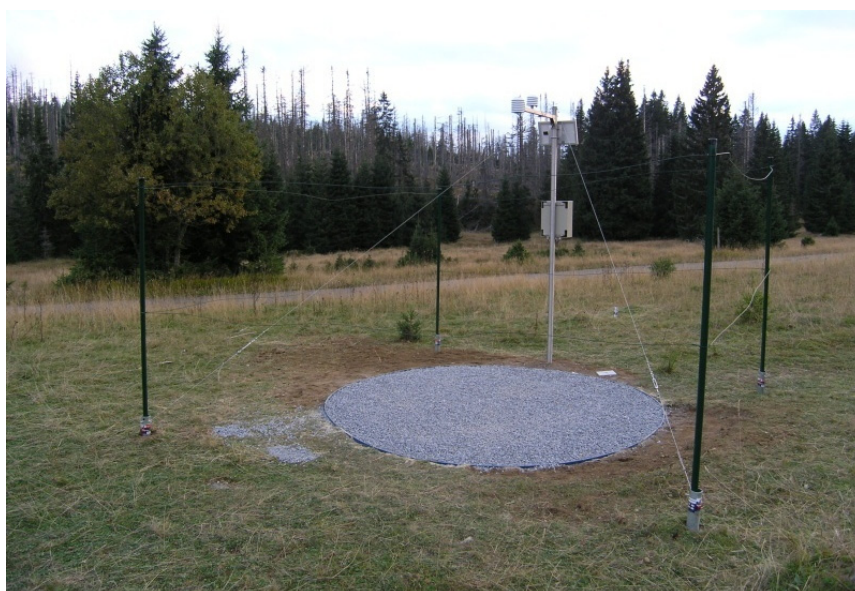
Obr. P.1 Automatická sněhoměrná stanice Javoří Pila na Šumavě.
