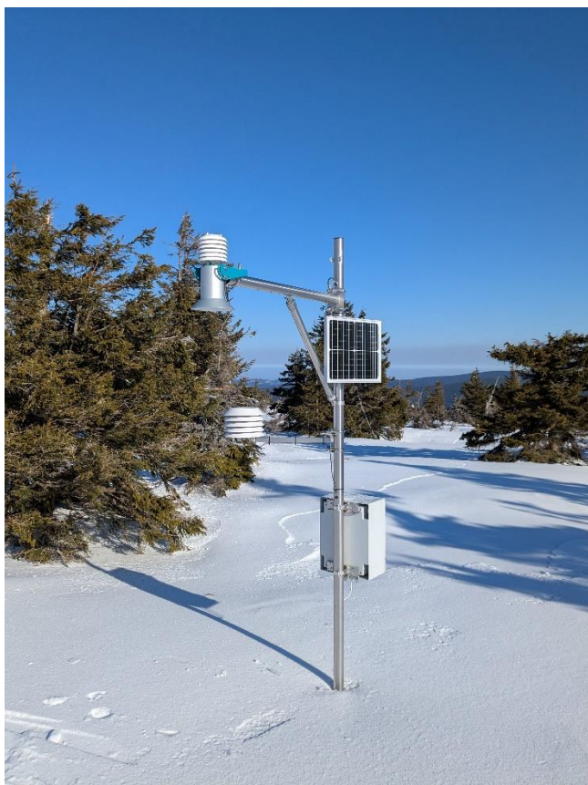
Obr. 26 Automatická sněhoměrná stanice Malý Děd 10. února 2025. Výška sněhu kolem 90 cm
