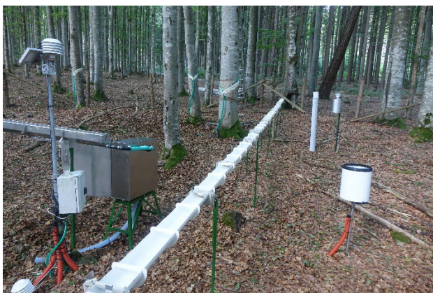
Obr. 28 Měření srážek v lesním porostu a ukázka měření srážek stékajících po stromech (foto Miroslav Tesař)
