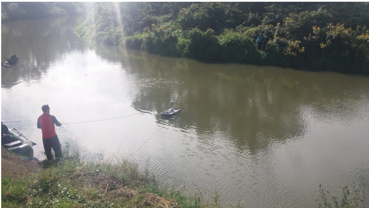
Obr. 2 Měření příčného profilu soustavou ADCP (autor Zdenka Krmelová)
