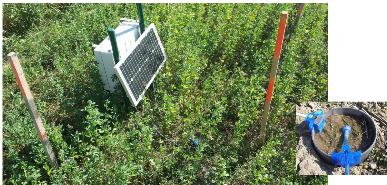
Obr. 2 Příklad instalace do porostu vojtěšky, vpravo dole detail válečku s hladinovým snímačem
