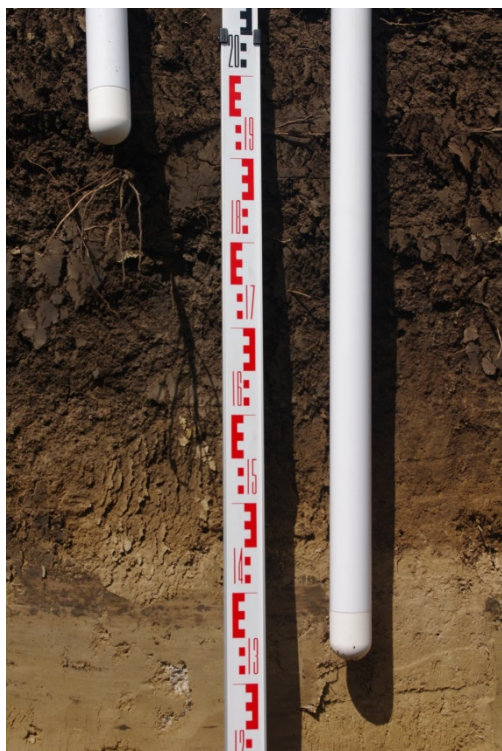
Obr. 2 Demonstrační foto podtlakových sběračů půdní pórové vody z půdy v hloubce 30 a 90 cm půdního profilu černozemě (ZD Sedlec) – plastová trubice opatřená keramickým porézním kalíškem. Reálná instalace je provedena ručním vrtáním v linii řádku mezi keři révy.
