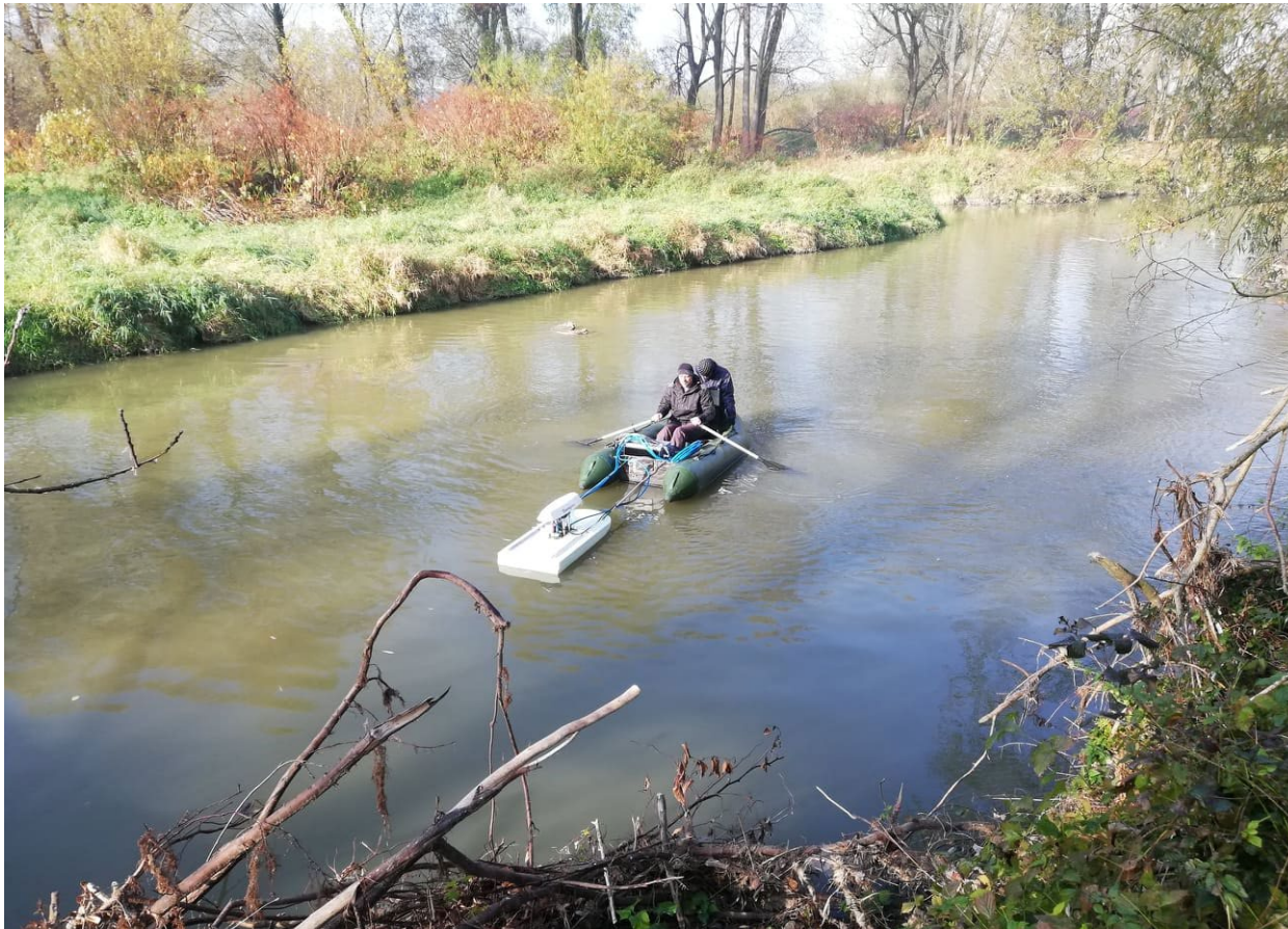
Obr. 3 Skenování Odry se skenerem GeoSwath 4R (Autor: Martin Bolek)
