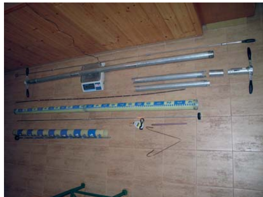
Obr. 4 Váhové sněhoměry používané na MS Lysá hora. Foto: 28. ledna 2019, Milan Čermák.
