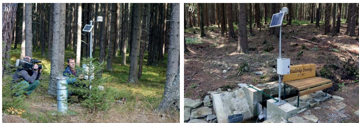
Obr. 4 Měření HPV, hydrochemických parametrů HPV a hydrometeorologických prvků na rozvodnici povodí Liz (a – vlevo, (foto: Miroslav Tesař, říjen 2018); měření průtoků a hydrometeorologických parametrů na jednom z pramenů v povodí Liz (b – vpravo, foto: Miroslav Tesař, červenec 2018).
