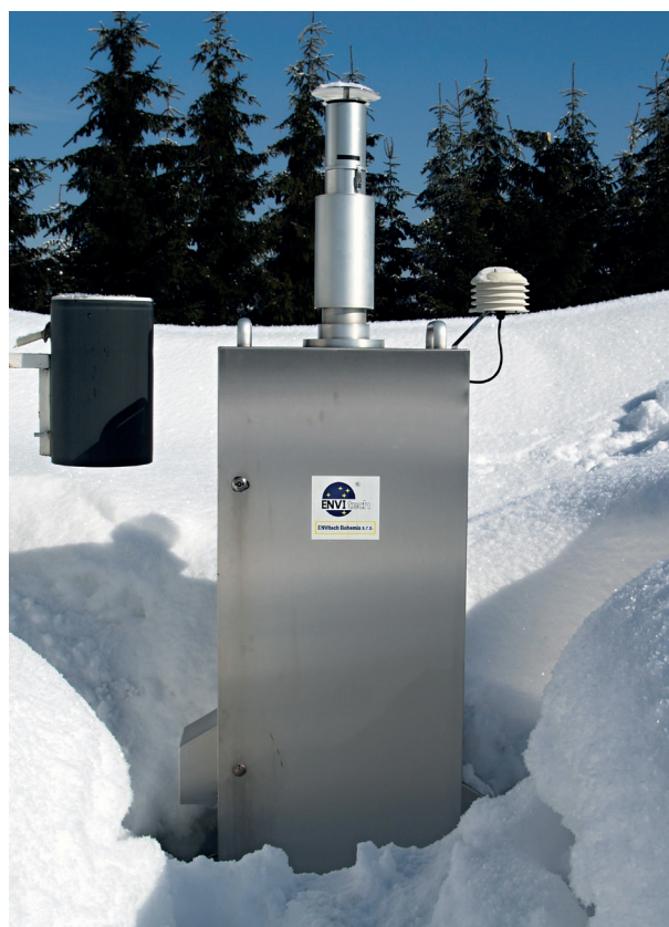
Obr. 30 Manuální vzorkovač suspendovaných částic na Bílém Kříži v Beskydech v roce 2006.
