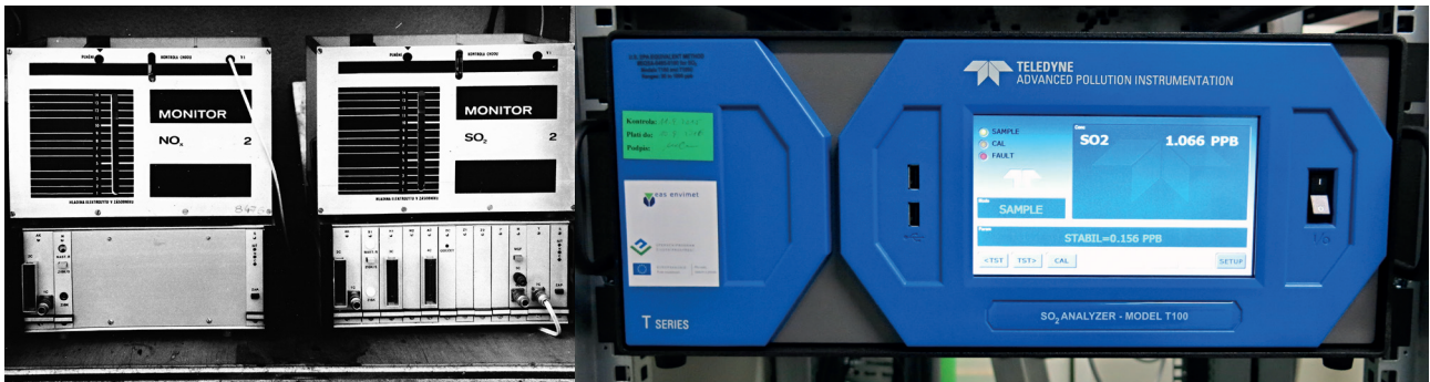
Obr. 31 Nejstarší a současný typ automatických měřidel ke stanovení koncentrací plynných škodlivin v ovzduší.
