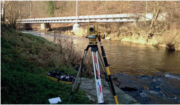
Obr. 22 Zaměřování příčných profilů pomocí totální stanice Topcon.
