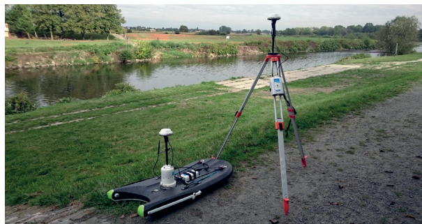
Obr. 21 ADCP přístroj SonTek RiverSurveyor M9, měření na řece Odře, ve stanici Bohumín s RTK jednotkou pro měření průtoků a příčných profilů s geodetickou přesností, který v současnosti představuje bezesporu nejpokročilejší přístroj pro měření průtoků.
