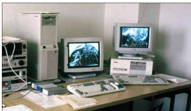
Obr. 7.7 Systém SDUS firmy UKW Technik, GmbH. Byť se ještě nejednalo o digitální snímky v pravém slova smyslu, systém umožňoval nejen statické zobrazení snímků na monitorech počítačů, ale poprvé i jejich animaci zachycující pohyb a vývoj oblačných systémů. Systém sloužil do začátku roku 1995.
