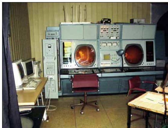
Obr. 4.6 Radar MRL-5 s digitalizačním a automatizačním doplňkem WRP-32C (v levé části obrázku).
