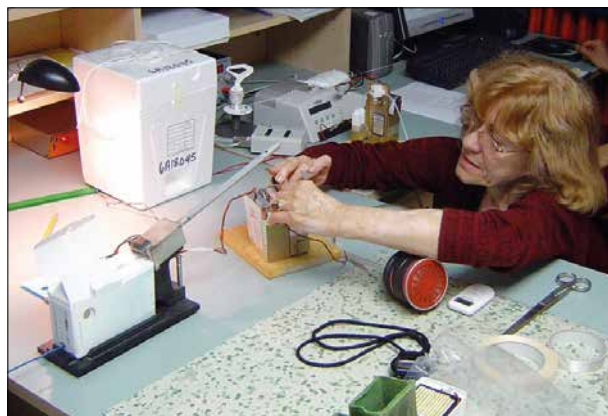
Obr. 2.7 Mgr. A. Benešová při předstartovní přípravě ozonové sondy ECC 6A.
