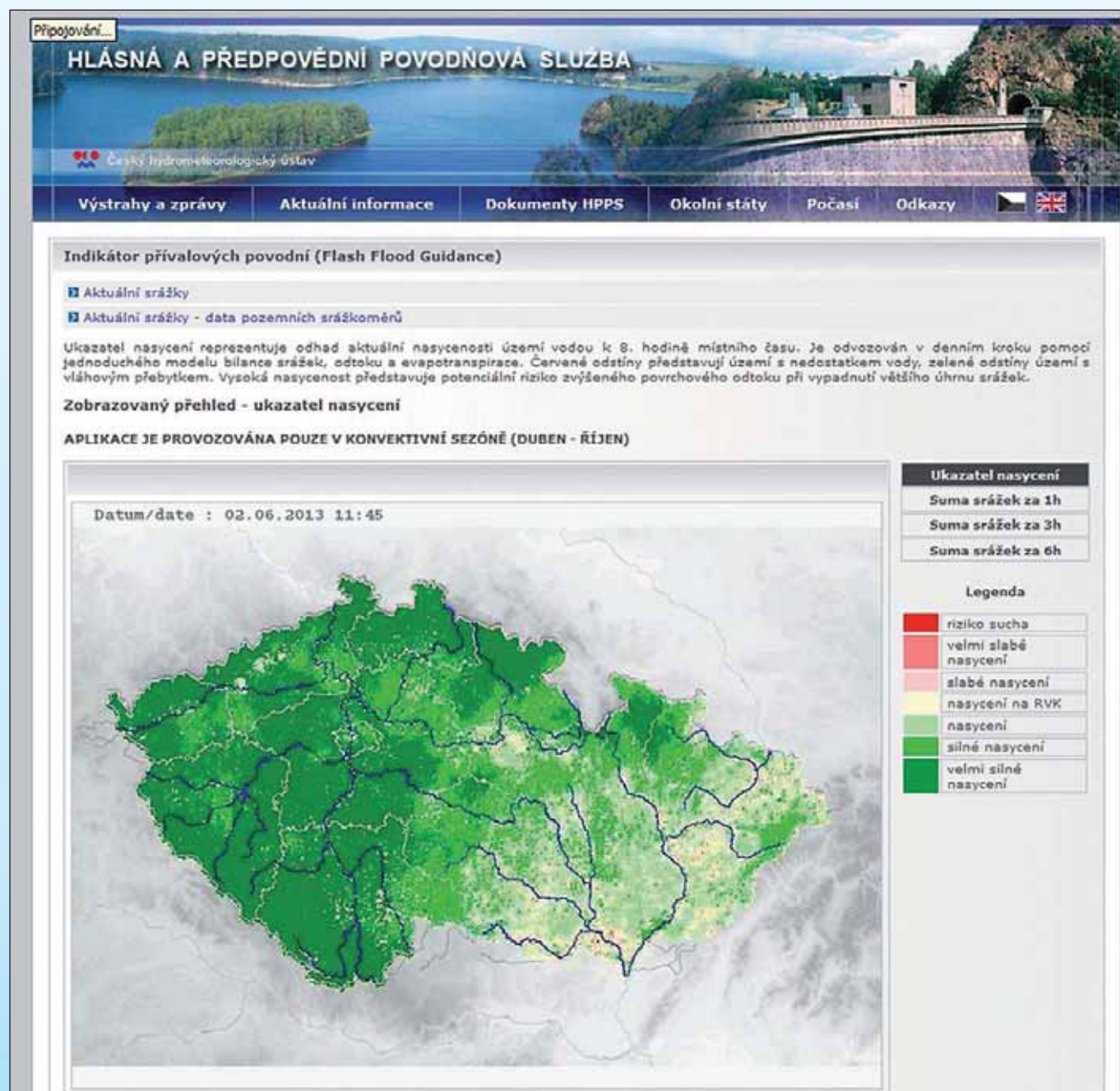
Obr. 7.6 Ukázka prezentace indikátoru přívalových povodní – limitní úhrn srážek o době trvání jedné hodiny, který by byl nebezpečný z hlediska vzniku přívalových povodní.
