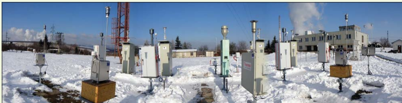
Měřicí místo na observatoři Tušimice připravené pro srovnávací měření přístrojů k měření PM_{10} a PM_{2.5} . The measuring point at the Tušimice Observatory, ready to test equivalence for equivalent PM_{10} a PM_{2.5} measuring devices.
