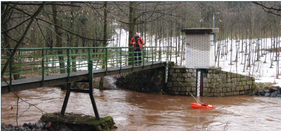
Měření průtoku pomocí přístroje ADCP na řece Jizeře. ADCP measurements on the Jizera.
