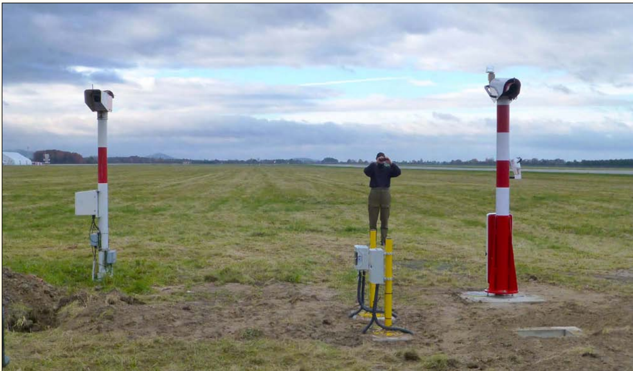
Starý typ (MITRAS single base, vlevo) a nový typ (LT31, vpravo) transmissometru vedle sebe. (Foto Ing. P. Černý). Old model (MITRAS, single base, left) and new model (LT31, right) of transmissometer (Photo P Černý).
