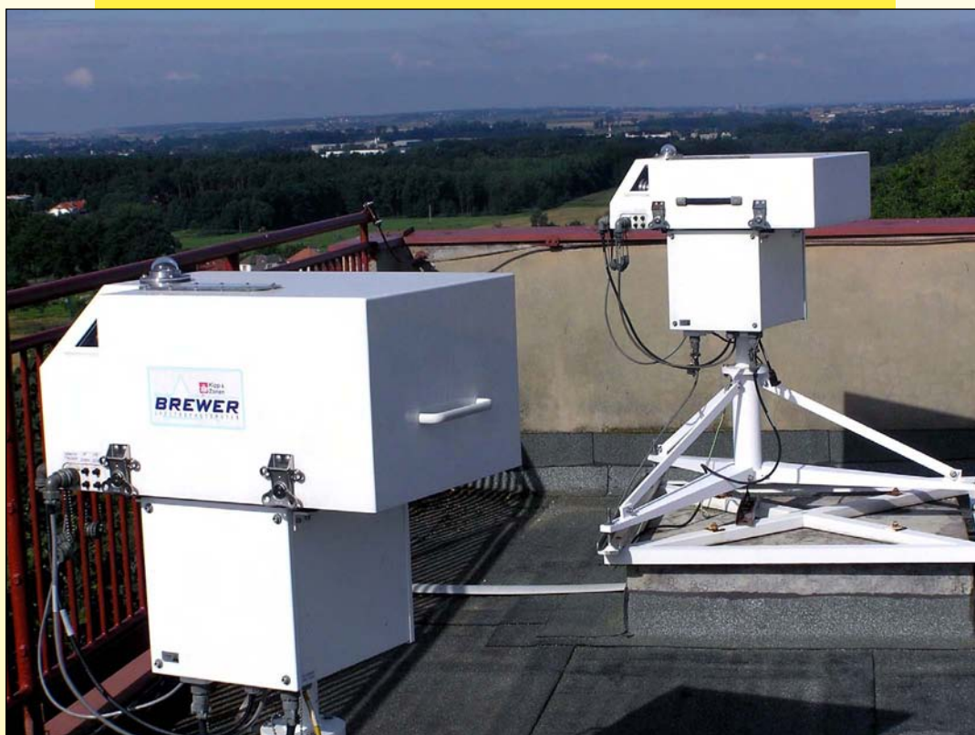
Brewerovy spektrofotometry B098 a B184 na SOO Hradec Králové. B098 and B184 Brewer spectrophotometers at the Hradec Králové Solar and Ozone Observatory.
