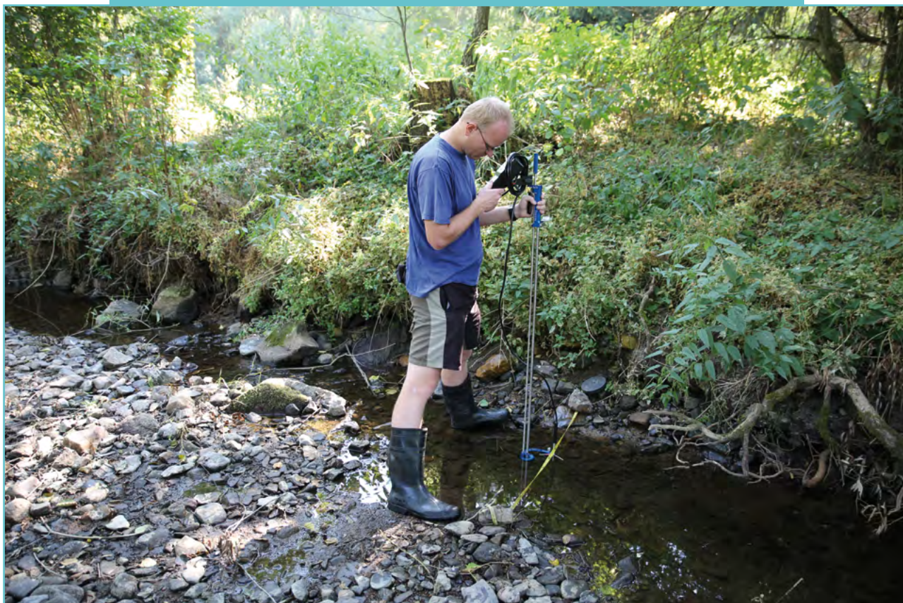
Měření průtoku přístrojem FlowTracker v profilu Hrachov na toku Brzina, 7. 8. 2015.
