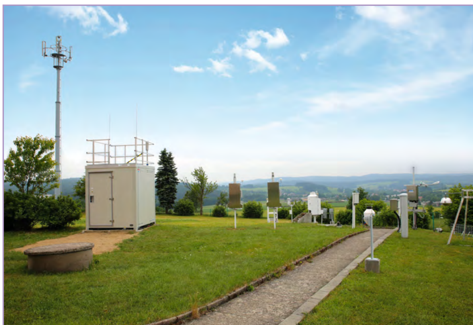
Modernizované zařízení státního imisního monitoringu na profesionální stanici ČHMÚ Svratouch. Modernised instrumentation in the national air pollution monitoring system at the CHMI's Svratouch professional station.
