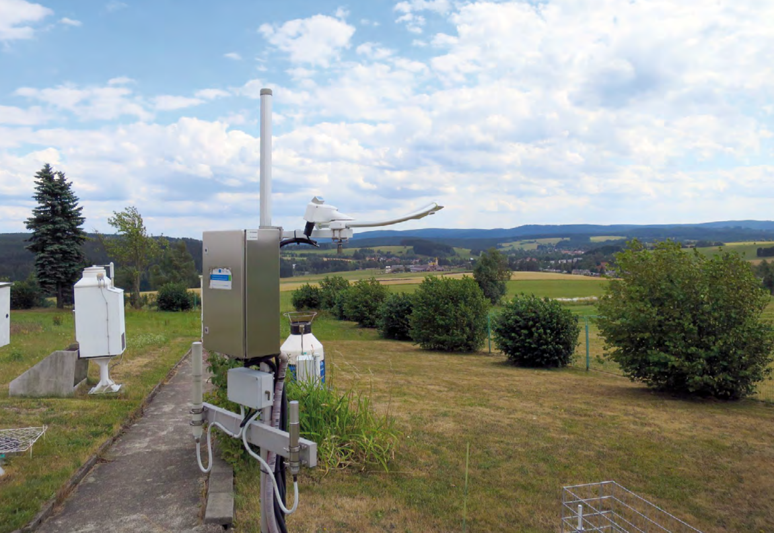
Nově instalovaný počasový senzor – dohledoměr PWD52 na MS Svratouch. New PWD52 present weather detector at the Svratouch MS.
