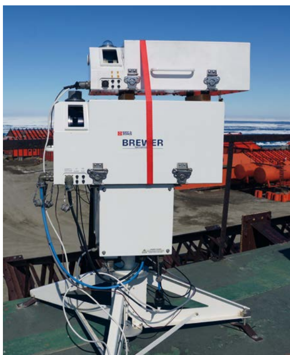
Brewerův spektrofotometr 199 při kalibraci. Základna Marambio, Antarktida, 2016.
